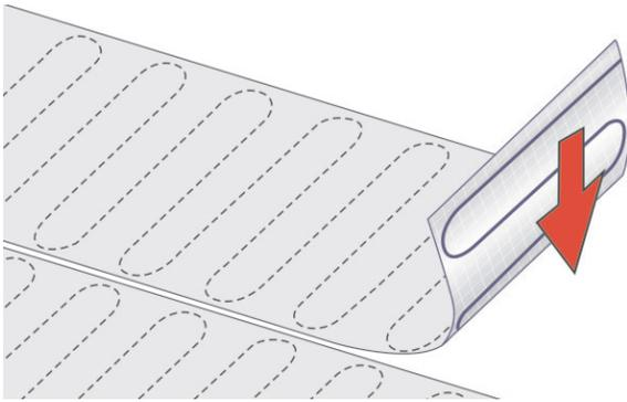
Installieren Sie die Heizmatte mit der Aluminiumfolie nach oben zum Fußbodenbelag.
