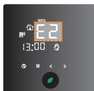
Ein Fehlercode E2 erscheint auf dem Display, wenn ein Fehler des Bodensensors vorliegt oder wenn kein Bodensensor durch Einstellung 02 oder 03 verbunden ist.
