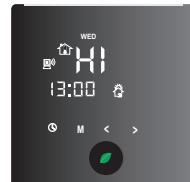
**HI** Anzeige für den Fall, dass eine Temperatur höher als +55°C erreicht wird.
