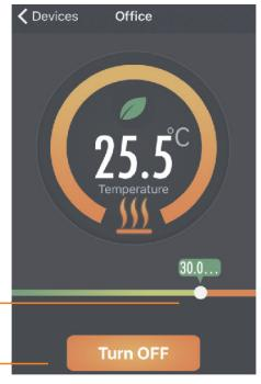
⑦ Réglage de la température ambiante et indication de température
